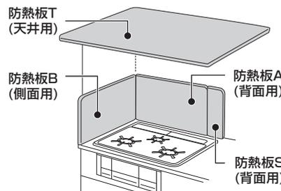
※機器を設置する周囲の壁などに可燃物(木製などの可燃性の壁、ステンレス板や薄いタイルなどの不燃材を可燃性の壁に直接貼り付けた壁、棚など)のある場合、防火上有効な間隔を確保できる場所に設置するか、防熱板による防火処置を行って下さい。
