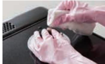
水気を十分にしぼった布で、温度センサーに手を添えて、汚れをふきとります。温度センサーが上下にスムーズに動くか確認しましょう。
