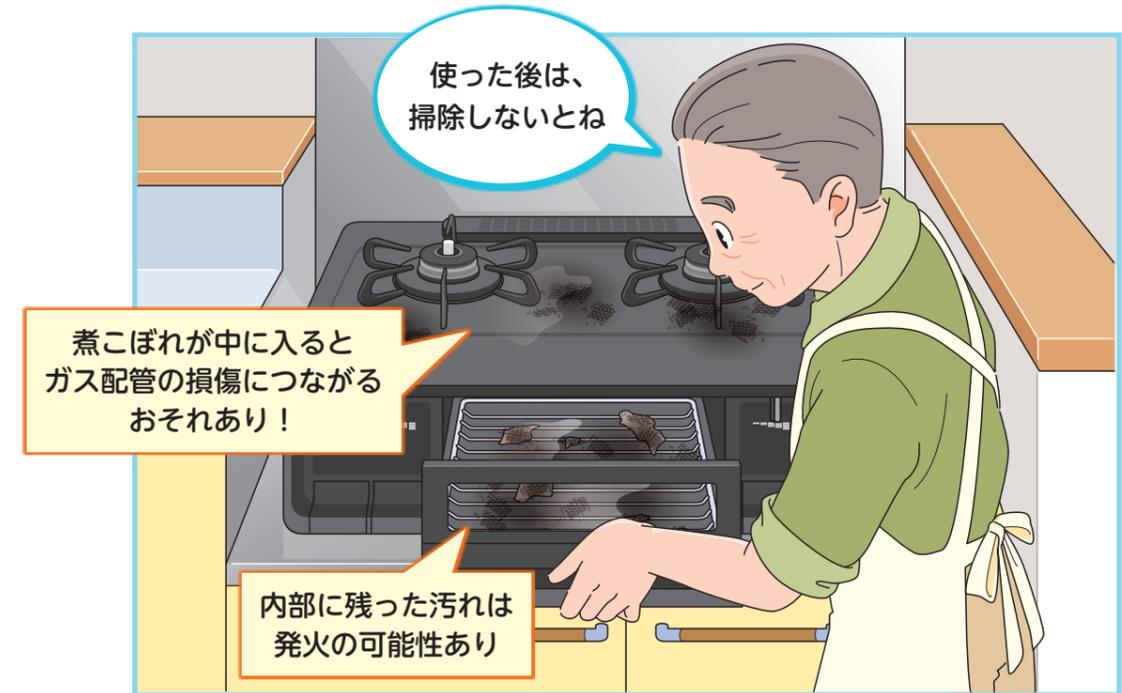
煮こぼれが起き、ガスの出口（バーナーキャップ）がふさがれると、点火がしにくくなったり、ガスがコンロの内部へ逆流し火災になるおそれがあります。また、度重なる煮こぼれが発生した場合には、コンロの内部のガス配管などが損傷し火災になるおそれがありますので、メーカーに点検をご依頼ください。
