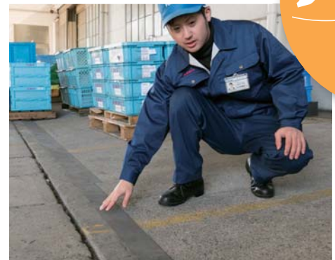
工場内の段差を解消し、フォークリフトなどに積載した部品の落下を防止
