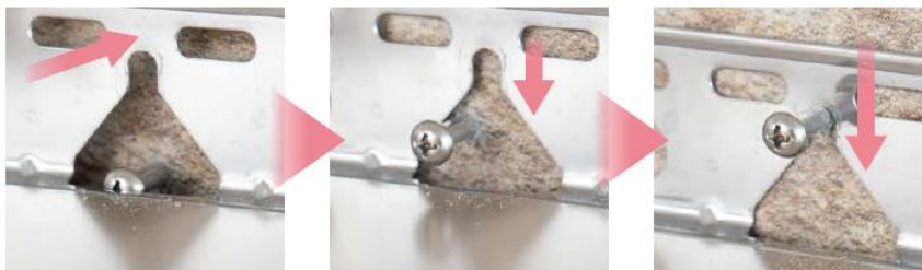
①ブラケットの穴を通す ②ガイドに沿って下ろす ③センターに掛かる
