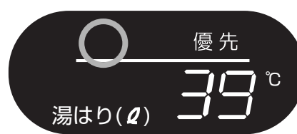
燃烧確認ランプ消灯
