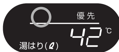
燃焼確認ランプ消灯
