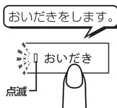
●おいだき温度点滅中においだきスイッチを押すごとに、「設定温度+1℃」→「設定温度+2℃」→「設定温度+3℃」→「おいだき 切」と調節できます。
