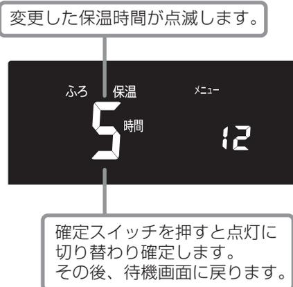
※確定スイッチを押さずに、そのまま約3分間放置すると、そのときの設定内容で自動的に設定が完了します。
