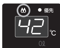
燃焼確認ランプ点灯
