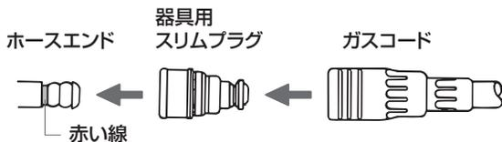
■ガス用ゴム管(ソフトコード)を使用する場合は、検査合格マークまたはJISマークの入っているものを使用し、赤線まで差し込んでゴム管止めでしっかり止める
