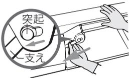
①支えを動かして突起を大きい穴に合わせ、内側にはずす
