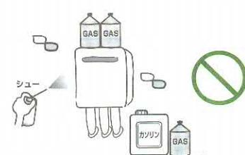
機器および排気口の周囲にスプレー缶を置かない、近付けない
