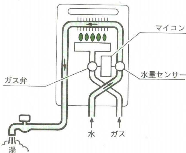
使用する給湯栓を開くと、給湯器内に水が流れます。この水の流れをセンサーが検出するとガス弁が開き、燃焼が始まりお湯ができます。
