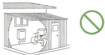
外壁の塗装や増改築、家屋の修繕時など養生シートで機器本体（排気口）を覆う場合は機器を使用しない
